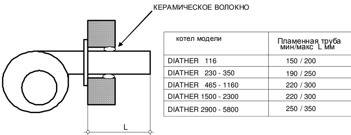
Установить горелку на дверцу котла при помощи крепежной пластины таким образом, чтобы пламя было параллельным и располагалось по центру топки; в противном случае могут иметь место проблемы при сгорании топлива, которые могут привести к серьезным повреждениям котла.
